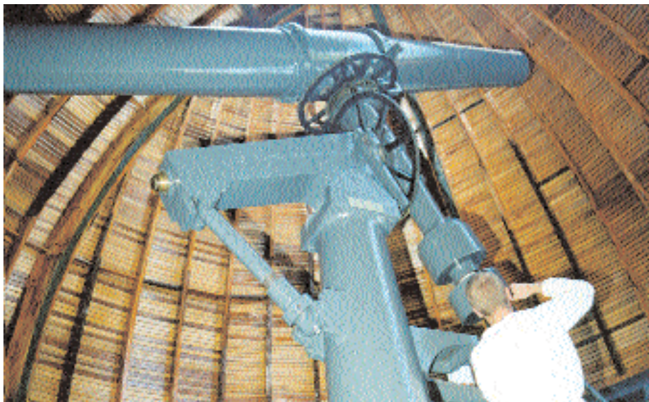
Figuras 9b – Pintura do instrumento com tinta esmalte sintético cinza.
