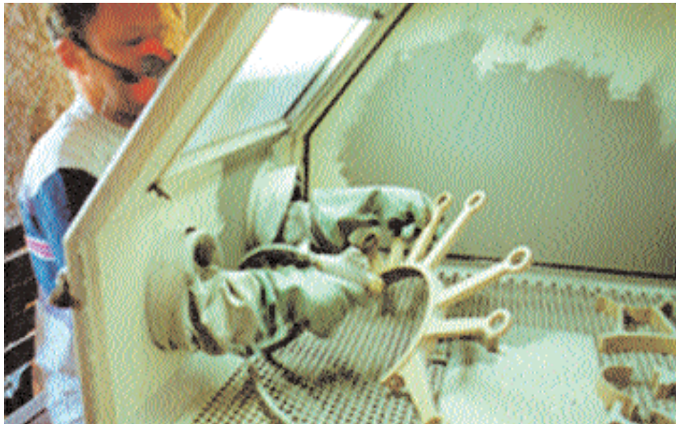
Figuras 9a – Polimento da superfície das peças de latão e bronze por jateamento com esferas de vidro.
